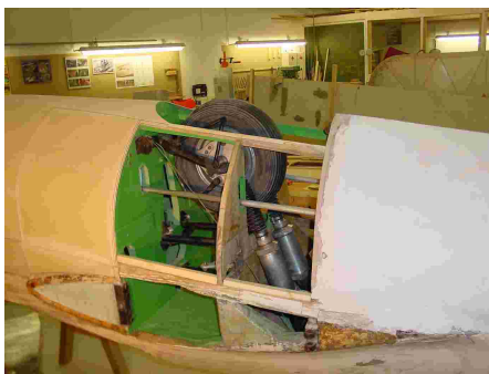
Das restaurierte Einzieh-Fahrwerk
